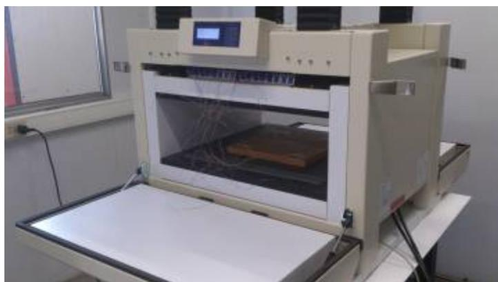
La conduttività termica misurata con termo flussimetro
