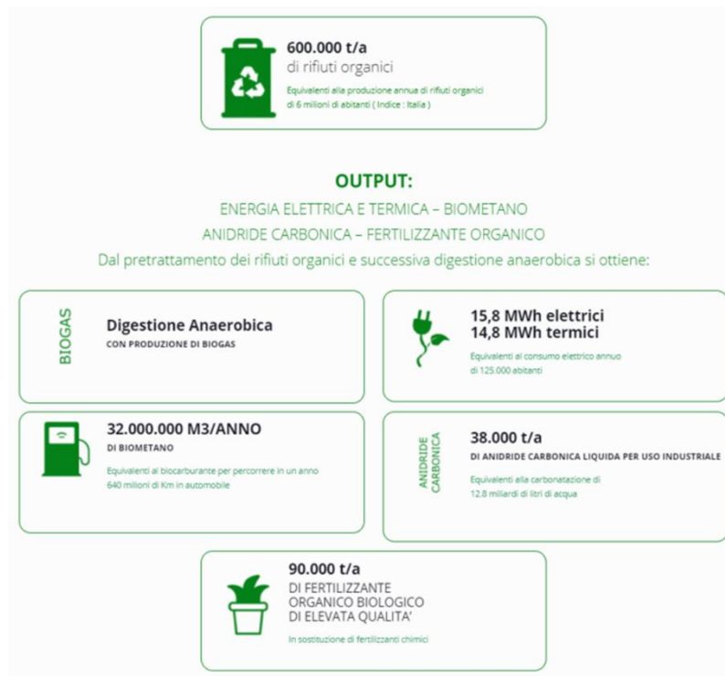
Figura 4.1– Impianto di trattamento della frazione organica di Montello. Sono riportati tutti i processi svolti e i prodotti generati (Fonte: www.montello-spa.it )
